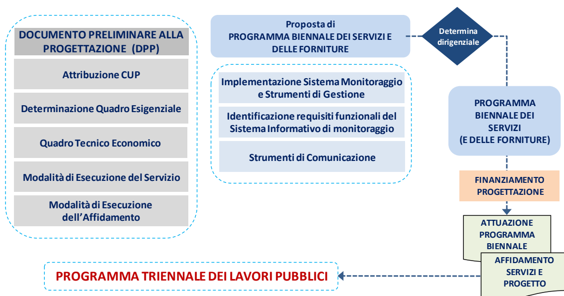
Schema 4. – Fase di start up del progetto e dei servizi di ingegneria
